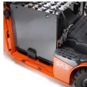
Zijdelings batterijwisselen met fork pockets
