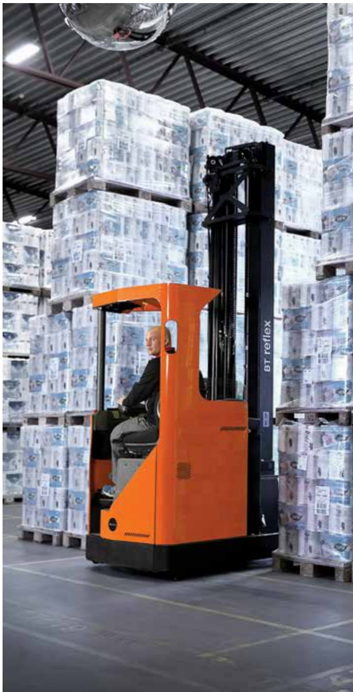
Het raam aan de achterzijde verbetert het zicht en zorgt ervoor dat de bestuurder in de truckcabine blijft, voor meer veiligheid.
