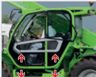
CS hydropneumatisch geveerde cabine kan door de bediener geactiveerd worden. Uniek in zijn genre, enkel beschikbaar bij Merlo.
